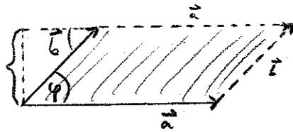
$\Rightarrow |\vec{a} \times \vec{b}| \hat{=} \underline{\text{Fläche des von } \vec{a}, \vec{b} \text{ aufgespannten Parallelogramms}}$
