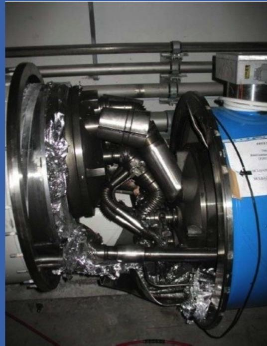
Leck in Heliumleitung → Supraleiter werden Leitend → Rund 2000A führen zu enormer Erhitzung und Verformung
