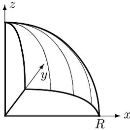
Das skizzierte Achtel (Masse  $M$ ) einer Kugel ( $R$ ) wurde aus einem homogenem Material hergestellt.
