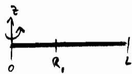
$$\tilde{I} = \begin{pmatrix} \cdot & \cdot & 0 \\ \cdot & \cdot & 0 \\ 0 & 0 & I_{33} \end{pmatrix} \begin{pmatrix} 0 \\ 0 \\ \omega \end{pmatrix} = \begin{pmatrix} 0 \\ 0 \\ I_{33}\omega \end{pmatrix}$$
