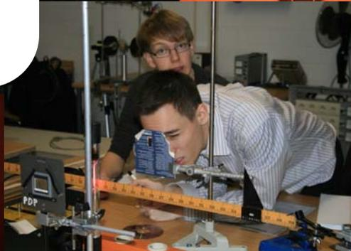
Betrachtung und Vermessung des Wasserstoffspektrums Mit einer CD – Station 1
