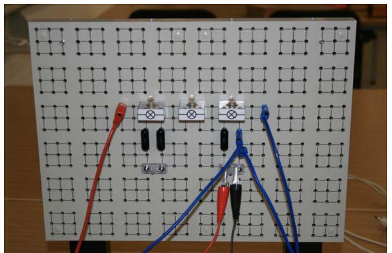
**Achtung:** Der Strom/Spannungssensor funktioniert nicht richtig, wenn das CBL2 über ein Netzteil mit seiner Betriebsspannung versorgt wird. Hier also in jedem Fall das CBL2 mit Batterien bestücken.
