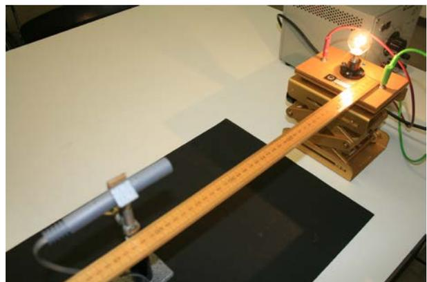
**Tip:** Glühlampe mit möglichst punktförmiger Glühwendel verwenden, z. B. aus einer Reuterlampe (6V/5A). Messung nicht ganz nah an der Lampe starten - aus größerer Entfernung sieht die Lichtquelle punktförmiger aus. Raum abdunkeln, Reflexion an Tisch oder Wand minimieren (deshalb die schwarze Pappe auf dem Tisch).
