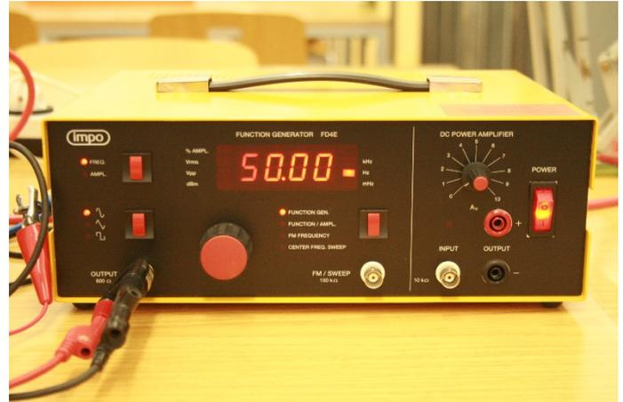
Einstellungen am Funktionsgenerator: 50 Hz (oder auch 100 Hz, oder andere ausprobieren). Amplitude so wählen, dass die induzierte Spannung 6 V nicht überschreitet (maximale Spannung des Spannungssensors). Bei der hier benutzten Kombination aus Generator und Spulen war das auch bei maximaler Amplitude nicht der Fall.
