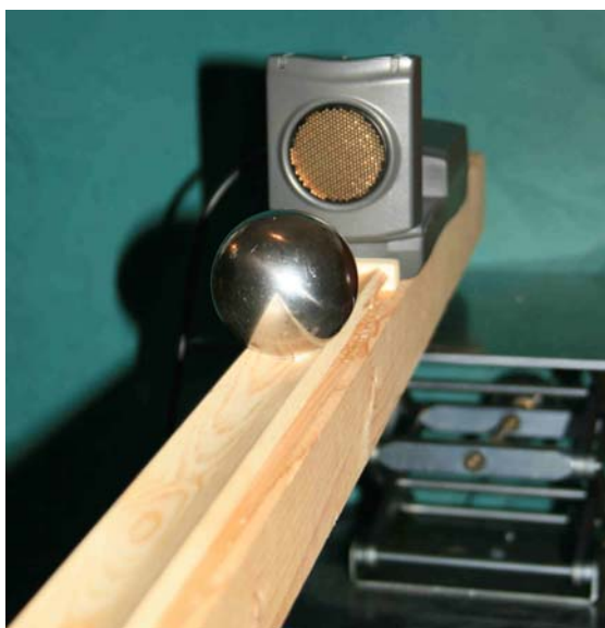
Abb. 9: Positionierung des Abstandssensors vor der Fallrinne.
