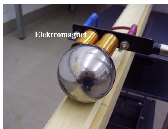
Abb. 2: Einfache Fallrinne. Der Elektromagnet hält die Kugel bis zum Start fest.
