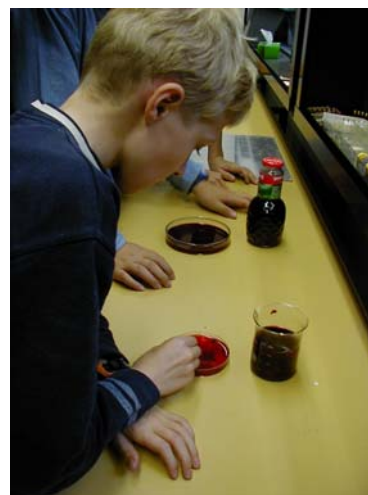
Abb. 3: Anfärben der \text{TiO}_2 -beschichteten Elektrode mit Hibiskustee
