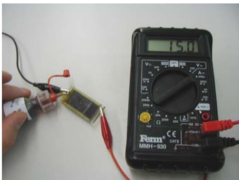
Abb. 5: Zwischen die Elektroden lässt man Jodlösung laufen: die Solarzelle beginnt zu arbeiten
