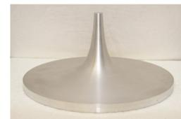
Der Potentialhügel wurde aus Aluminium gedreht, von Hand geschliffen, poliert und bündig in eine Hartfaserplatte eingesetzt.
