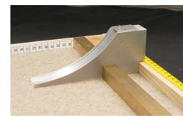
Aufgeleimte Maßbänder erlauben Messungen des Streuwinkels und die genaue Einstellung des Stoßparameters.
