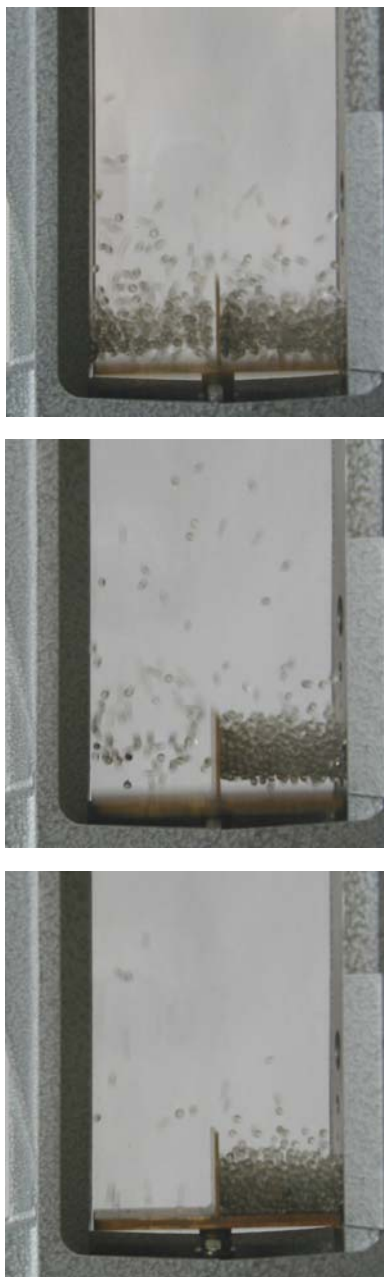
Abb. 2: Momentaufnahmen der Auswirkung der Energiedissipation im nur wenig modifizierten Modellversuch zur kinetischen Gastheorie: die Kugeln versammeln sich alle in einer der beiden Kammern.
