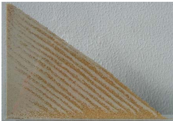
Abb. 8: „Zebrastrifen“. Entmischung eines Granulatgemischs aus großen, kantigen Teilchen (brauner Rohrzucker) und kleinen, glatten Teilchen (Quarzsand) in einem Plexiglastasten mit 0.5 cm Plattenabstand.
