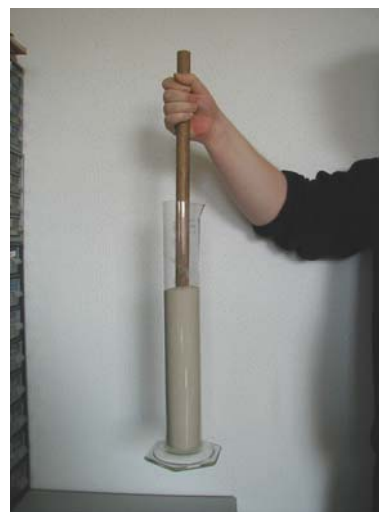
Abb. 25: Experiment zur Brückenbildung. Ein sandgefüllter Behälter kann an einem sich im Sand befindenden Stab hochgehoben werden, wenn im Sand Brückenbildung provoziert wurde.
