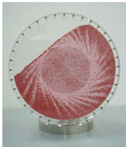
Abb. 16: „Feuerrad“. Langsame Rotation einer Mischung aus grobem Dekosand (rot) und Haushaltszucker (weiß).
