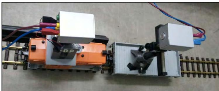
Abbildung 49: Versuchsaufbau Dämpfungsmessung
