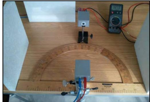
Abbildung 40: Versuchsaufbau Winkelabhängigkeit
