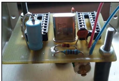
Abbildung 44: Veränderte Platine des UG mit Drehkondensator
