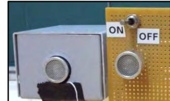
Abbildung 59: Ausrichtung beider Sender
