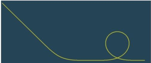
Dieses Programm simuliert eine Achterbahnfahrt durch verschiedene Loopingformen. Dabei werden Geschwindigkeit und Anpressdruck (Normalbeschleunigung) des Wagens zeitlich aufgezeichnet. Die Fahrt beginnt auf einer **Rampe**, auf der der Wagen zunächst Geschwindigkeit gewinnen soll. Diese Rampe hat eine maximale Höhe von 40 Metern und besteht aus folgenden Abschnitten:
