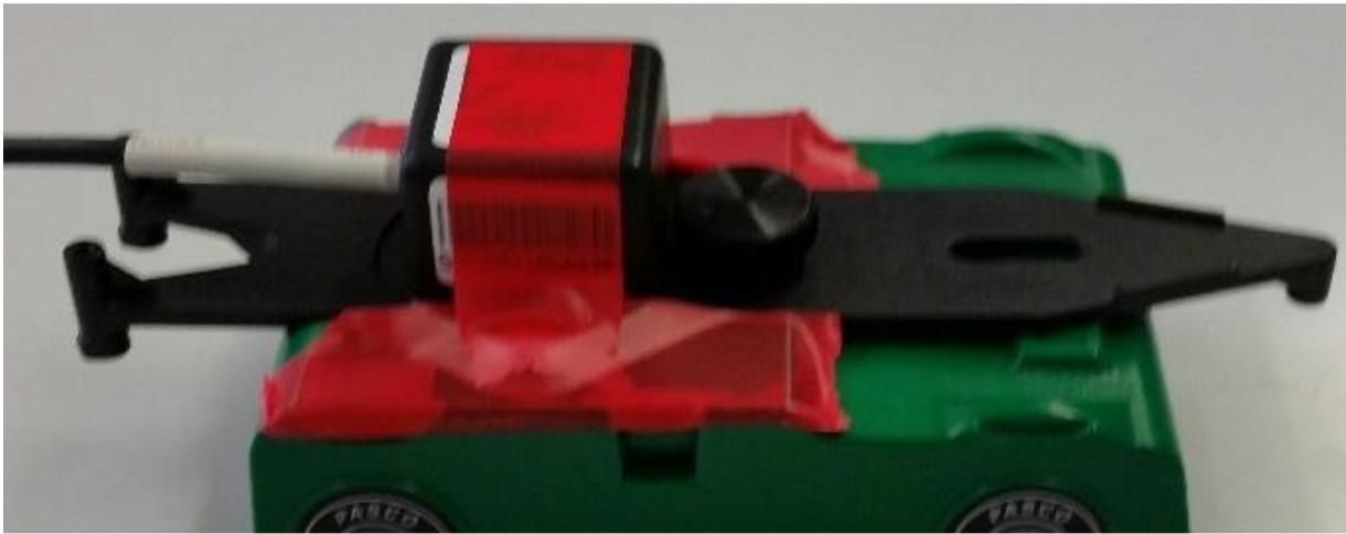
*Abb. 16: Wagen des Pasco RollerCoaster-Systems mit befestigtem 3-Achsenbeschleunigungssensor
