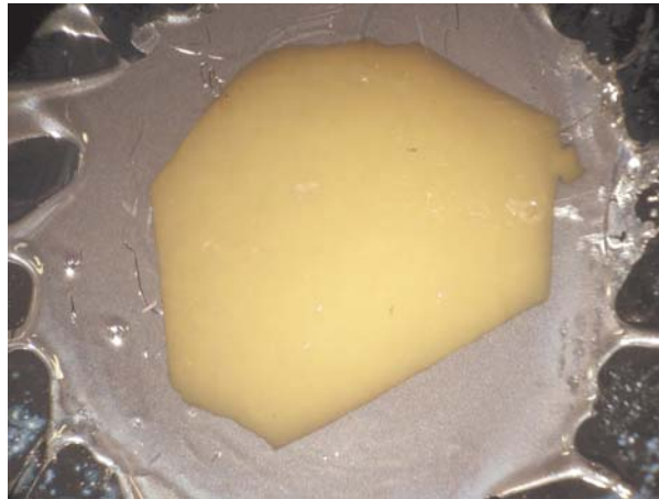
Abbildung 5.5: Der Elektrolyt aus Abb.5.1 mit aufgedampfter Silberelektrode.
