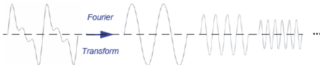
Abbildung 5.2: Bei der Fourier-Transformation wird ein Signal in Sinus- bzw. Kosinus-Funktionen zerlegt [Mis, 2010]
