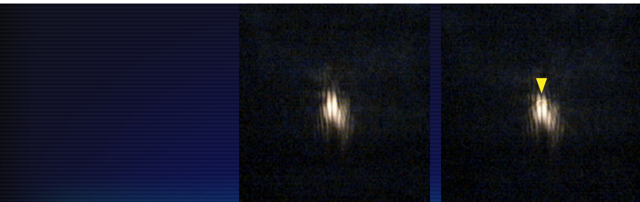
Abbildung 6.5: Aufnahmen des anregenden Laserspots. Links: Spot ohne Spitze. Rechts: die Spitze ist in den Strahl gefahren, erkennbar an den Reflexen (Markierung).
