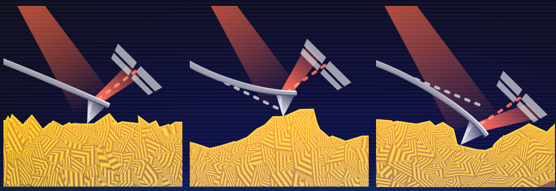
Abbildung 5.2: Je nach Auslenkung des Cantilevers wird Licht in einen anderen Teil der Quadrantenodiode reflektiert.
