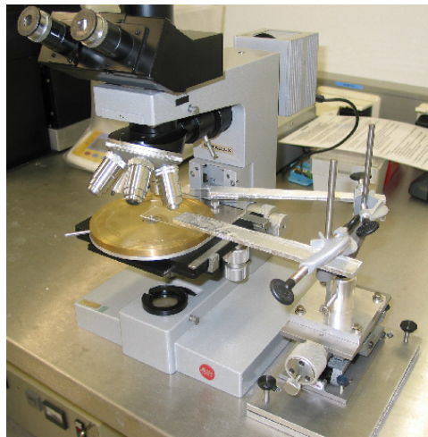
Abbildung 6.1 Komplette Alignment Einheit, bestehend aus Lichtmikroskop inkl. XY-Tisch und Drehteller, sowie Kippplatte mit einer Haltevorrichtung.
