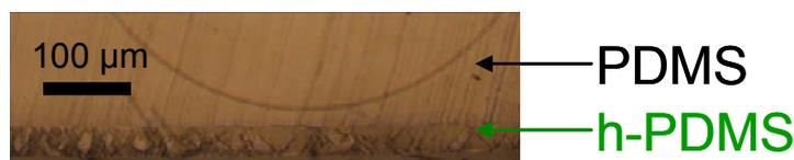
**Abbildung 32: PDMS-Doppelschicht**
