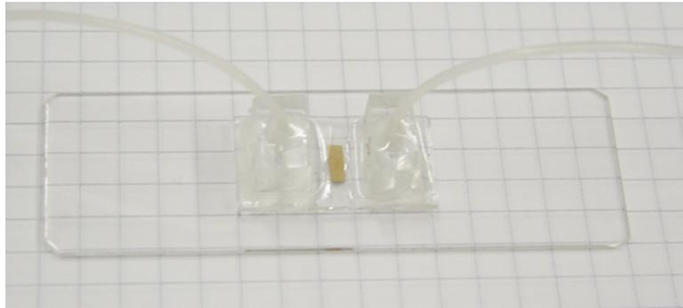
Abbildung 3.17: *Foto eines Objektträgers mit aufgesetzter Flusszelle*
