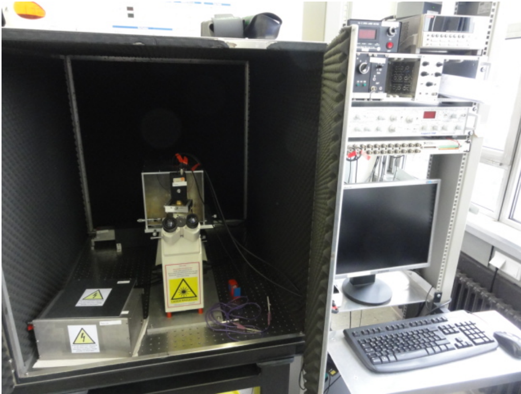
Abbildung 3.4: Foto des Messaufbaus für die Leitwertmessungen und die DNA Translokationsexperimente. Links zu sehen ist ein schall- und schwingungsgedämpfter Tisch, mit einer lichtdicht verschließbaren Messkammer. In dieser befindet sich eine weitere verschließbare Messkammer, in der die Flusszellen an die Elektroden angeschlossen worden sind. Der zu sehende Laser und das Lichtmikroskop wurden für diese Experimente nicht genutzt. Von den genutzten Geräten sind rechts der Computer zu sehen, sowie der BNC-Adapter und Axopatch (von unten nach oben).
