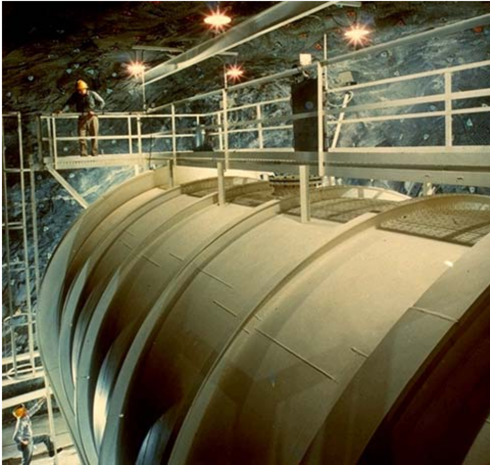
Homestake-Mine: Erster Nachweis solarer {}^8\text{B} -Neutrinos mit der Reaktion {}^{37}\text{Cl} + \nu_e \rightarrow {}^{37}\text{Ar} + e^- . Nachweisschwelle: E_\nu = 0,814 \text{ MeV} Quelle: Nick Strobel http://www.astronomynotes.com
