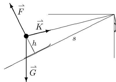
(a) Konstruieren Sie zuerst den dritten Einheitsvektor  $\vec{e}_K$  in Seilzugrichtung. Aus zwei Gleichungen für zwei Unbekannte (den Kraftbeträgen  $K$  und  $F$ ) ergeben sich schließlich  $\vec{K}$  und  $\vec{F}$  je in Komponentendarstellung. [Hinweis: Es herrscht Kräftegleichgewicht  $\vec{F} + \vec{G} + \vec{K} = \vec{0}$ .]
