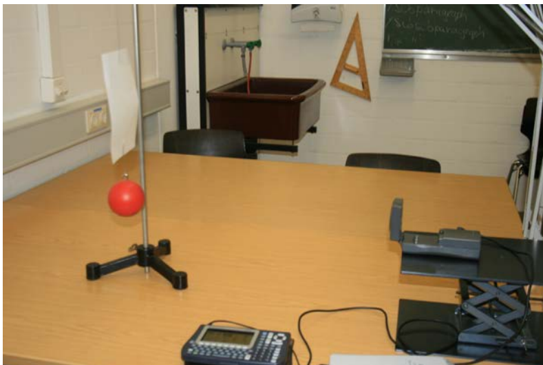
Versuchsaufbau für die gedämpfte Schwingung.
