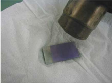
Föhne die Glasplatte anschließend trocken.
