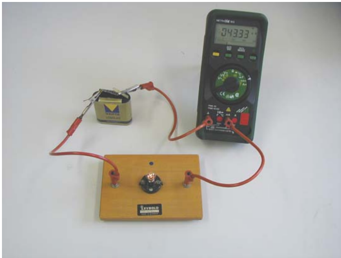
Abb. 1.2 Versuchsaufbau zur Messung der Stromstärke
