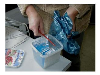
9. Lade eine Plastiktüte durch Reiben mit der Hand auf. Berühre mit dem einen Drahtende des eben gebauten Gerätes die Alublättchen, mit dem anderen die Plastiktüte.
