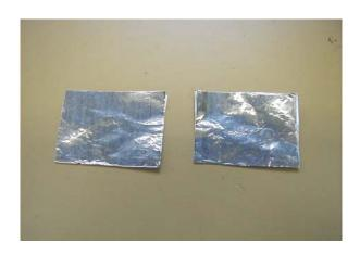
3. Schneide zwei genau gleichgroße Rechtecke Alufolie aus. Länge 6 cm, Breite 4 cm. Streiche sie mit dem Finger ganz glatt und knicke sie in der Mitte durch.
