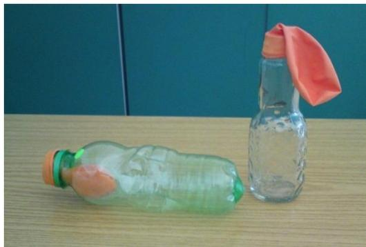
Die Abbildung 3 demonstriert die Versuchsaufbauten zur Visualisierung des Verhaltens von Luft auf Temperaturveränderungen.
