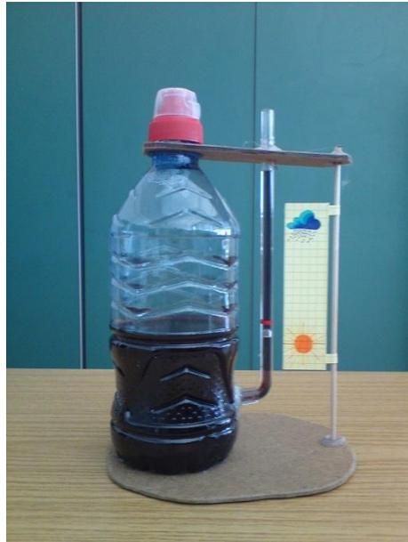
Die Abbildung 13 gibt einen möglichen Aufbau des (Goethe-)Barometers wieder.
