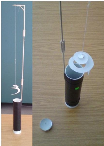
Die Abbildung 4 zeigt den Versuchsaufbau zur Veranschaulichung der physikalischen Eigenschaft der Luft, dass sie nach Erwärmung aufsteigt.
