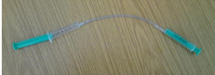
Die Abbildung 2 zeigt den Versuchsaufbau zu dem Versuch >>kommunizierende Spritzen<<. Dieser Versuch soll verdeutlichen, dass Luft Materie ist, die man verschieben kann.
