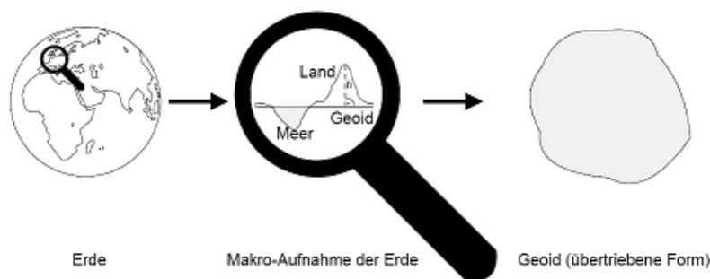
Abbildung 1.13: Annäherung der Erdoberfläche durch den Geoiden
