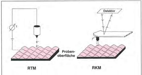
Schematische Darstellung der Rastertunnel- und der Rasterkraftmikroskopie. Während man bei der Rastertunnelmikroskopie (RTM) den zwischen Sensor und Probe angelegten, winzigen Strom misst, werden bei der Rasterkraftmikroskopie (RKM) die zwischen den Atomen der Sensorspitze und der zu untersuchende Probe wirkende Kräfte gemessen. Die Sensoren
