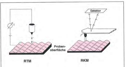
Schematische Darstellung der Rastertunnel- und der Rasterkraftmikroskopie. Während man bei der Rastertunnelmikroskopie (RTM) den zwischen
