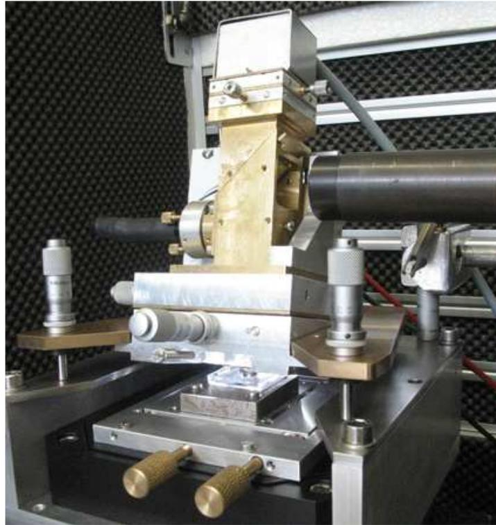
Abbildung 3.4: AFM incl. Piezotisch und Kamera
