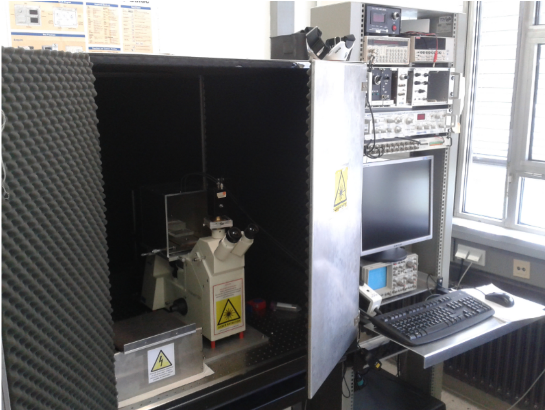
ABBILDUNG 3.4: Fotografie des Messaufbaus für die Leitwertmessungen. Auf der linken Seite befindet sich eine schwingungs- und schallgedämpfte, lichtdicht verschließbare Messkammer. In ihrem Innenraum befindet sich eine weitere verschließbare Messkammer auf einem invertierten Lichtmikroskop, in der sich die Auflage für die Flusszellen und die Headstage des Axopatch mit den beiden Elektroden befindet. Das Lichtmikroskop und der ebenfalls abgebildete Laser sind für die hier durchgeführten Versuche nicht relevant. Auf der rechten Seite befinden sich die Messgeräte und Steuereinheiten, von denen hier der BNC-Adapter und der Axopatch (von unten nach oben, über dem Bildschirm), sowie der Laborcomputer zum Einsatz kommen.
