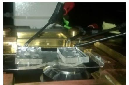
**Abbildung 16:** Fotografie eines Mikrofluidchips auf dem Objektträger, verbunden mit einzelnen PDMS-Blöcken und angeschlossenen Elektroden.
