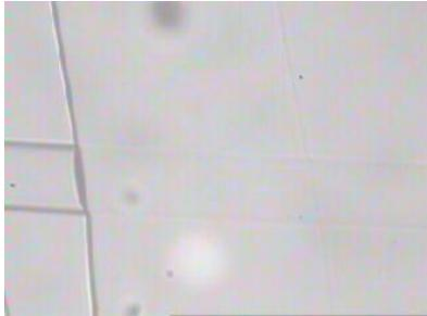
**Abbildung 30:** Es ist die Wechselwirkung von PDMS und Pepton abgebildet. Der Probenfluss (von rechts) staut sich an dem Riss im Kanal und bewirkt die Opazität des PDMS. Der Teil des Kanals rechts vom Riss ist dabei kaum mehr zu erkennen.
