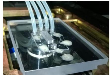
**Abbildung 15:** Fotografie eines mit dem Plexiglas verbundenen Mikrofluidchip und einer angeschlossenen Pumpe, fixiert auf dem Objektträger.
