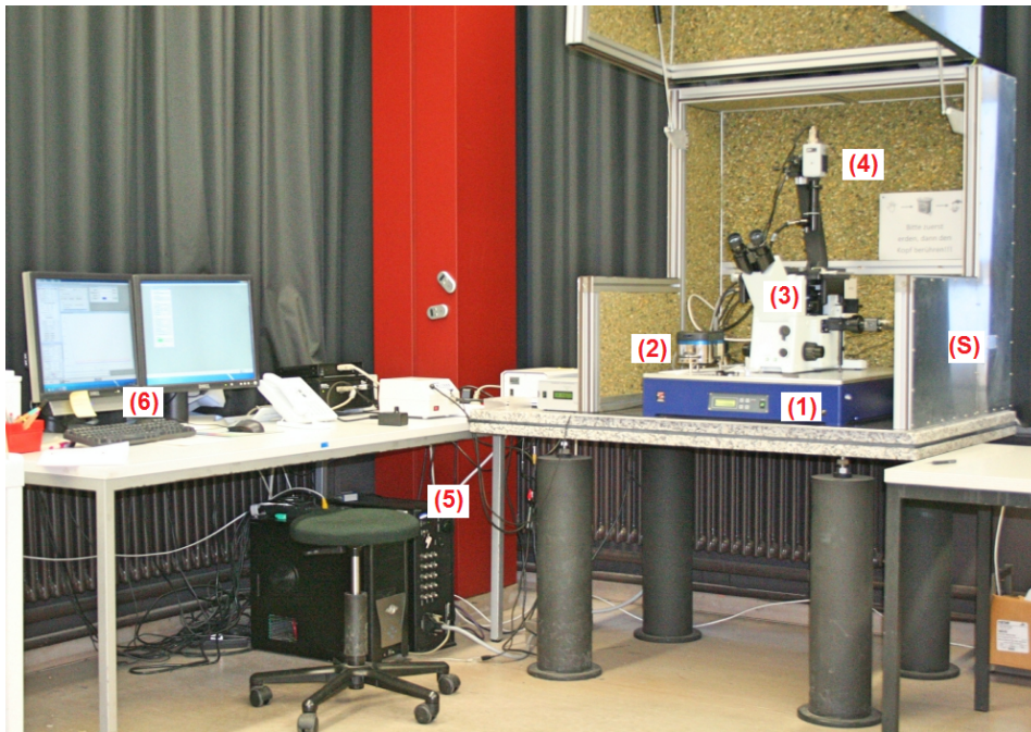
Abb. 3.1.2: Messaufbau Rasterkraftmikroskop mit (1)Vibrations-Isolations-Tisch [TableStable TS-300LT] ( JRS Scientific Instruments, 8932 Mettmenstetten, Switzerland ), (2)AFM-Kopf, (3)Olympus IX71, (4)Kamera für Laserausrichtung, (5)Controller, (6)Messrechner mit IGOR und einer (S) Schallschutzbox
